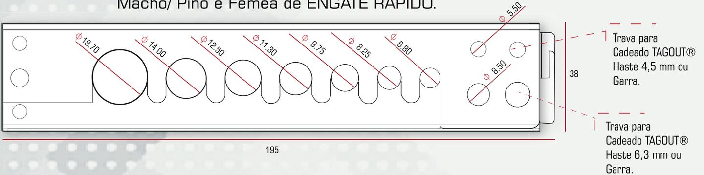
(DBPCQS) O modelo abaixo foi desenvolvido para proporcionar maior segurança nos bloqueios para componentes e acessórios pneumáticos do TIPO QS. Confirmar as medidas do componente que será bloqueado.
